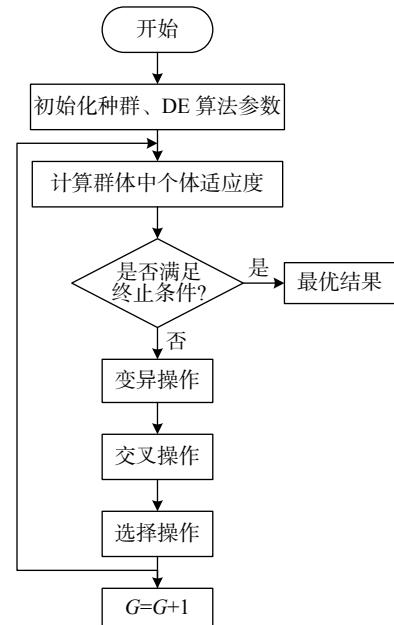
图 1 差分进化算法流程图
