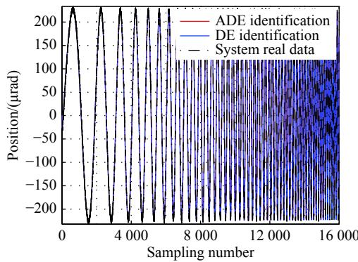
图 7 差分进化算法辨识输出与系统实际输出结果比较
