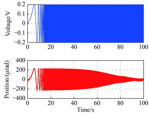
图 5 精跟踪系统开环输入-输出响应图
