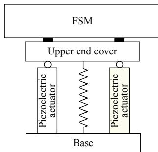
图 4 快速反射镜结构简图
