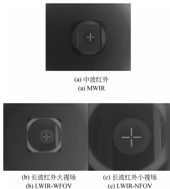
图 13 十字靶标的红外成像效果
