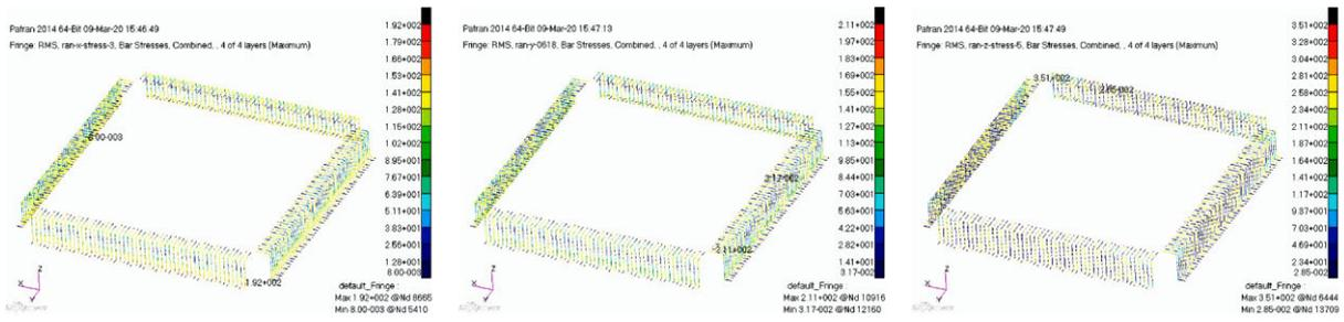
(a) X方向随机振动RMS应力(3σ)云图 (b) Y方向随机振动RMS应力(3σ)云图 (c) Z方向随机振动RMS应力(3σ)云图
