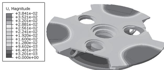
(b) 光学元器件组件重力载荷、-2°C 温度载荷下变形
