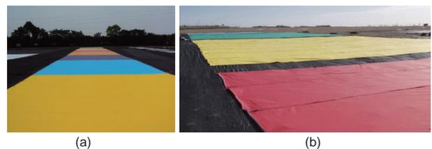
图2 (网络版彩图)光谱性能评价靶标实物图(a)和高光谱验证靶标实物图(b)
