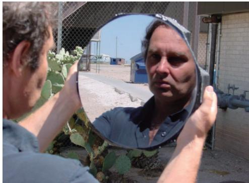
图 7 美国 MER 公司生产的 SiC-SiC 反射镜<sup>[48]</sup>
