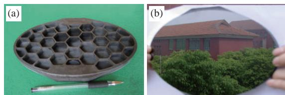
图 9 LSI 得到的椭圆形 C/SiC 反射镜<sup>[50]</sup>
