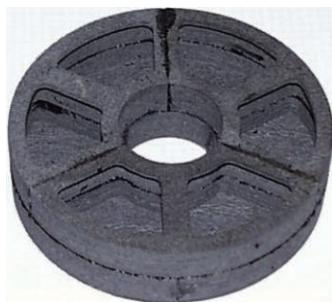
图2 六部分连接组成的镜坯<sup>[41]</sup>
