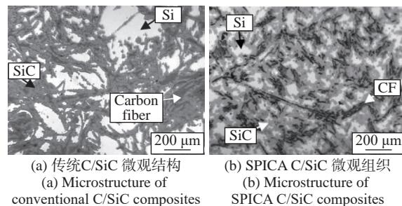
图5 传统C/SiC和SPICA C/SiC微观结构对比<sup>[45]</sup>
