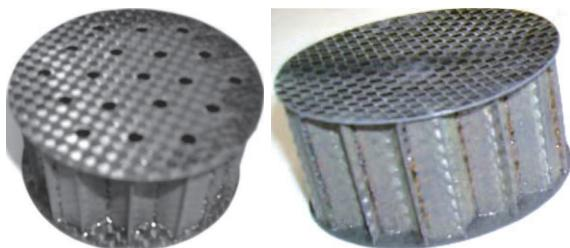
图 6 开孔式背板和弯曲式前面板<sup>[47]</sup>
