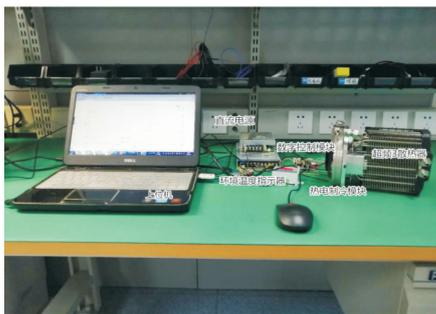
图 7 CMOS 图像传感器热电制冷控制系统实验平台实物
