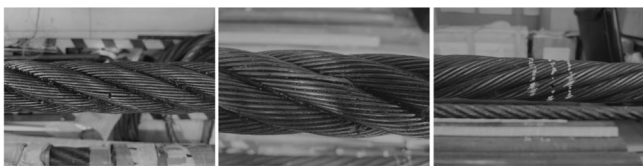
(a) 表面多根断丝 (b) 表面单根断丝 (c) 绳股沟槽间单根断丝 图6 缺陷示意图
