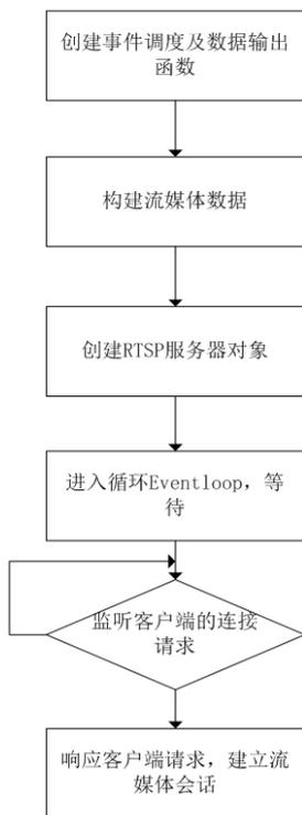
图 4: RTSP 服务器的基本设计流程
