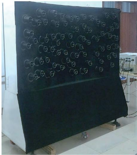
图 9 高精度大视场多星模拟器实物图
