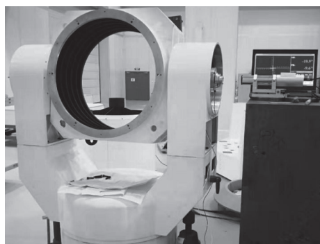
图11 跟踪架俯仰轴系晃动测试
