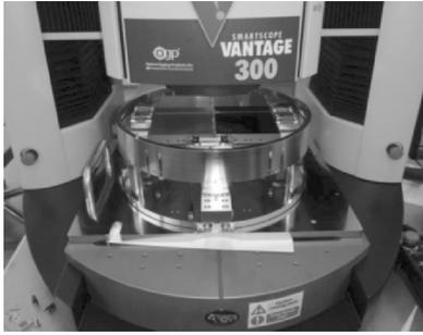
图 9 使用 OGP\_SmartScope Vantage 300 测量 KMTNet 拼接探测器的平面度<sup>[17]</sup>
