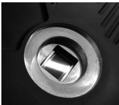
图 9 相机保护玻璃及其端面的反光现象
