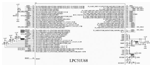
图 3 LPC51U68 主控芯片外围电路原理图
