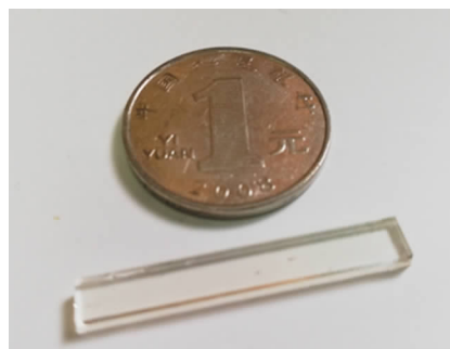
图 3 集成光学移相干涉仪芯片
