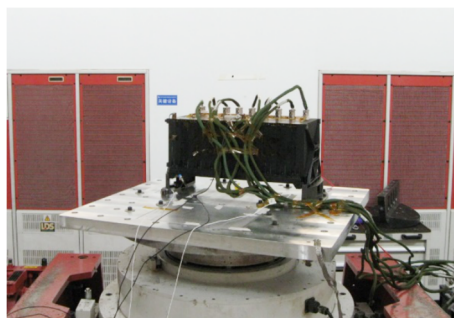
图 7 成像单元力学试验
