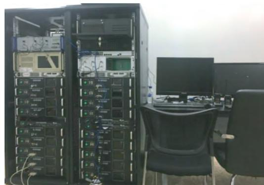
图 4 波前处理器以及高压放大器电子学系统的实物照片
