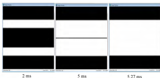
图 10 闪光灯延迟工作成像结果(曝光:2/5/5.27 ms,延迟:5 ms,闪光灯点亮时间:1 ms)
