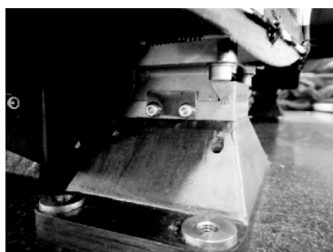
图 12 平动支座实验照片
