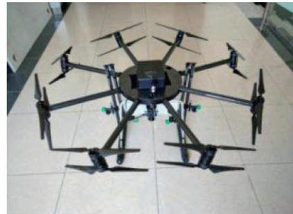
图 2 八轴十六旋翼试验平台
