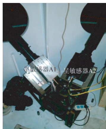
图 9 船载星敏感器外场试验图
