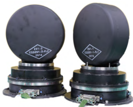
图 5 控制力矩陀螺示意图
