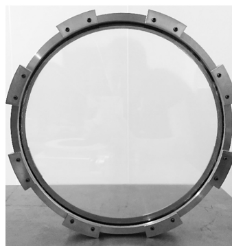
图 13 320 mm 口径菲涅尔薄膜实物图
