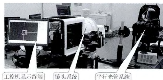
图12 系统星点和分辨率检测方案
