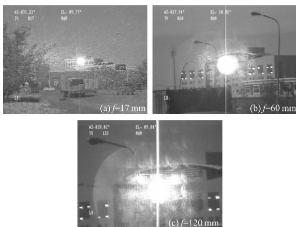
图 8 变焦彩色 CCD 成像系统的激光干扰效果
