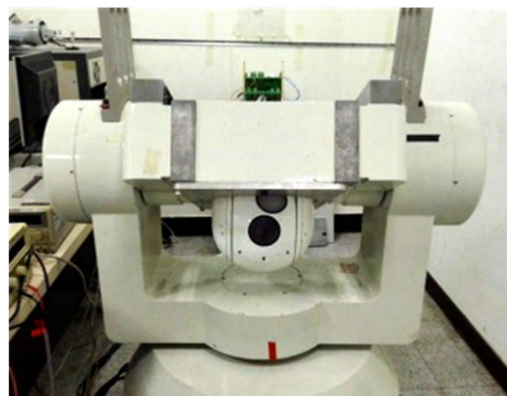
图 6 模拟飞机姿态变化的摇摆台
