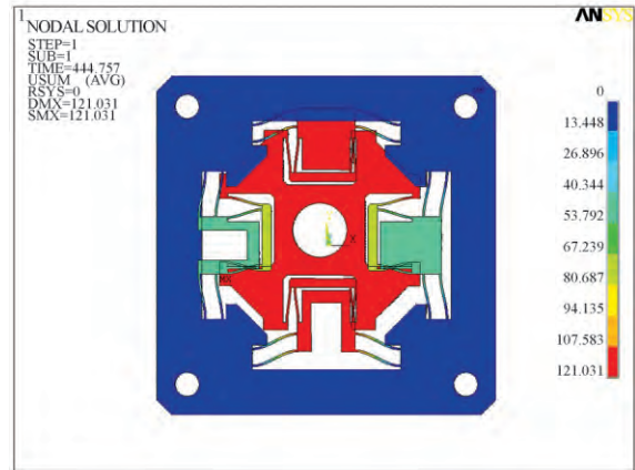
图 8 微位移平台的一阶模态 Fig. 8 Diagram of first-order modal shape of micro-motion stage
