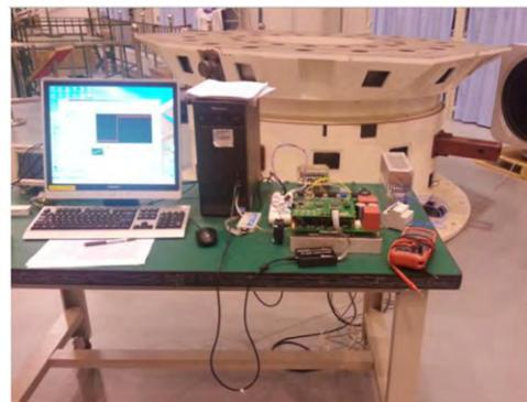
图 14 望远镜转台硬件控制系统
