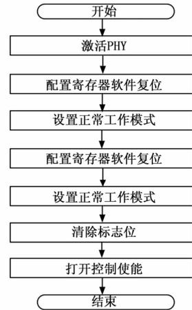
图 6 DM9000A 初始化流程图
