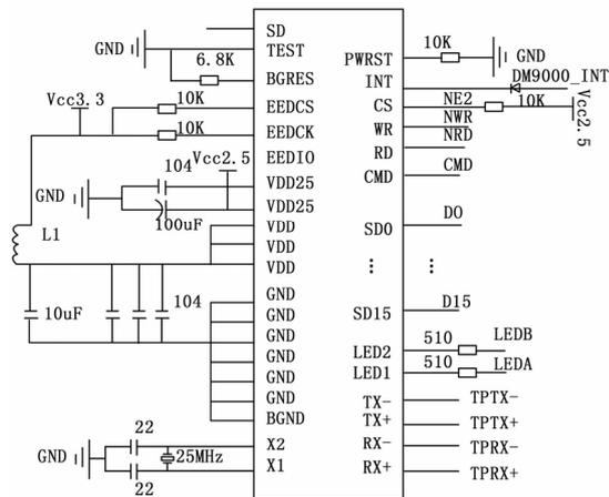
图 3 DM9000A 硬件接线图
