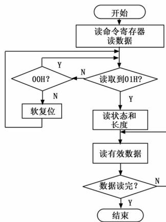
图 8 DM9000A 接收流程图
