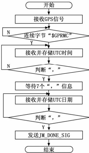
图 5 GPS 解码软件流程图
