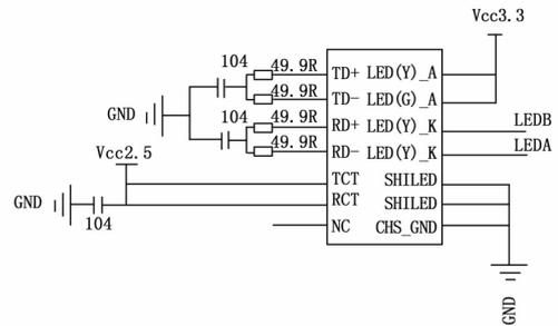
图 4 RJ45 硬件接线图
