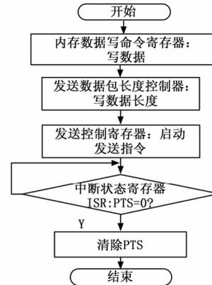
图 7 DM9000A 发送流程图
