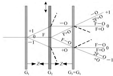
图4 三光栅系统原理图
