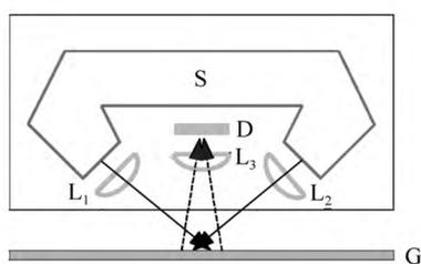
图 6 微型光栅位移测量系统原理图
