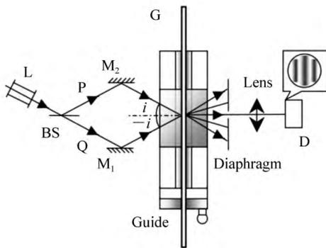
图 9 光栅干涉位移测量系统光路图
