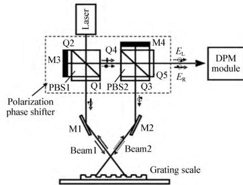
图 11 采用 Littrow 结构的光栅位移测量系统原理图
