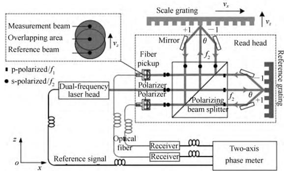
图 14 外差光栅位移测量系统原理图
