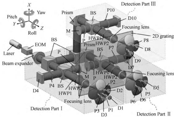
图 13 6-DOF 测量系统原理图
