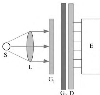
图 1 基于几何莫尔条纹原理的光栅位移测量系统结构简图
