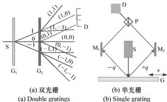
图 2 基于衍射干涉原理的光栅位移测量系统结构简图
