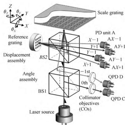
图 8 6 自由度测量系统原理图
