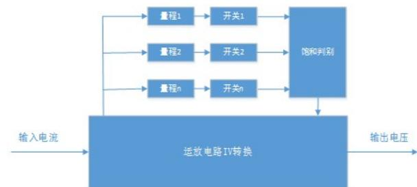
图 3 可变量程 I/V 转换电路
