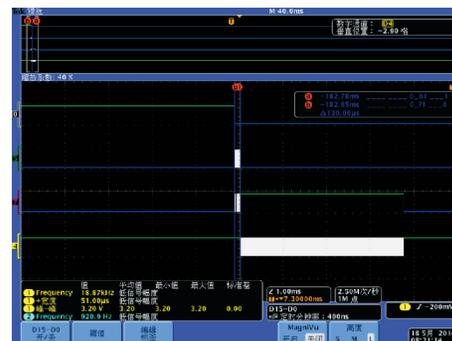
图 6 掉电后数据存储实测波形
