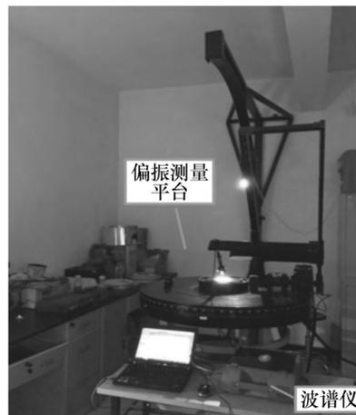
图 1 多角度偏振测量平台
