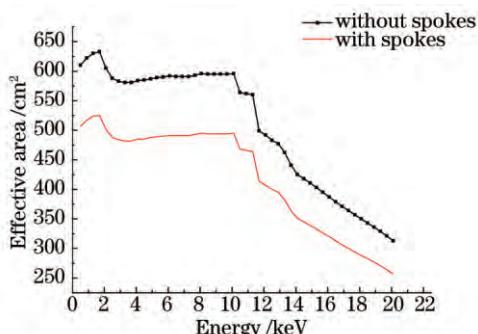
图4 无辐条和有辐条时不同波段的轴上有效面积
