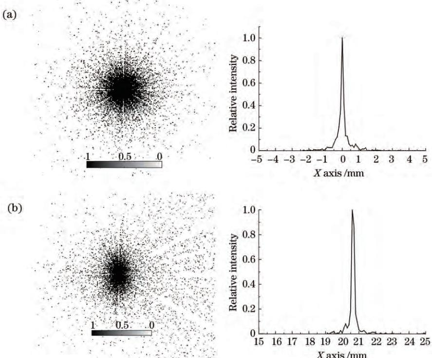
图 7 像面点列图和二维点扩展函数。(a)  $0^\circ$  视场; (b)  $14'$  视场
