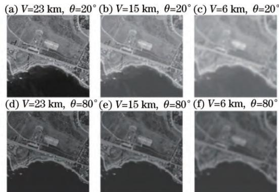
图 8 自动调光处理后的遥感图像
