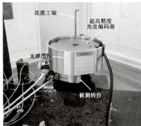
图8 转角精度测量装置实物图
