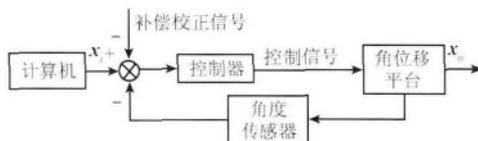
图6 误差补偿校正方法原理框图
