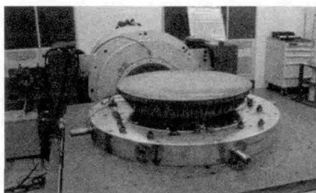
图 23 反射镜组件力学振动试验
