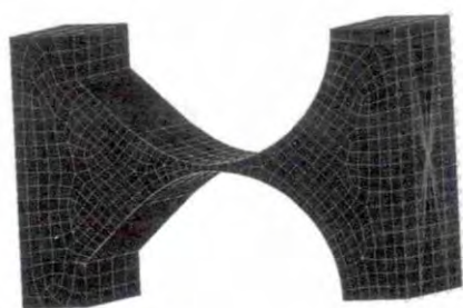
图 3 双曲线直圆混合柔性铰链的有限元模型
