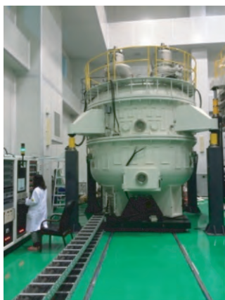
图 2 \Phi 3.2 m 磁控溅射镀膜机照片
