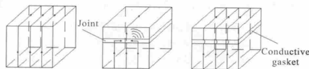
图 5 导电衬垫的屏蔽机理
