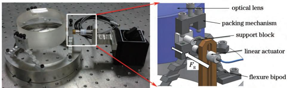
图 12 径向预紧力施加装置示意图
