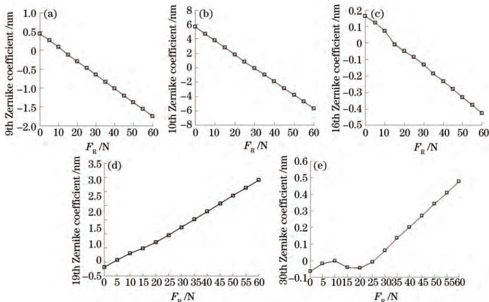
图 11 各项泽尼克系数随预紧力的变化曲线。(a) 第 9 项泽尼克系数; (b) 第 10 项泽尼克系数; (c) 第 16 项泽尼克系数;
