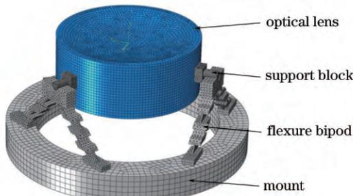
图4 柔性双脚架支撑结构有限元模型
