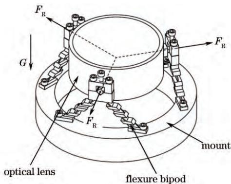
图1 反射镜运动学支撑结构示意图
