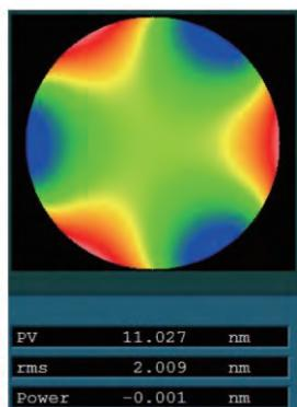
图5 重力单独作用时的反射镜面形
