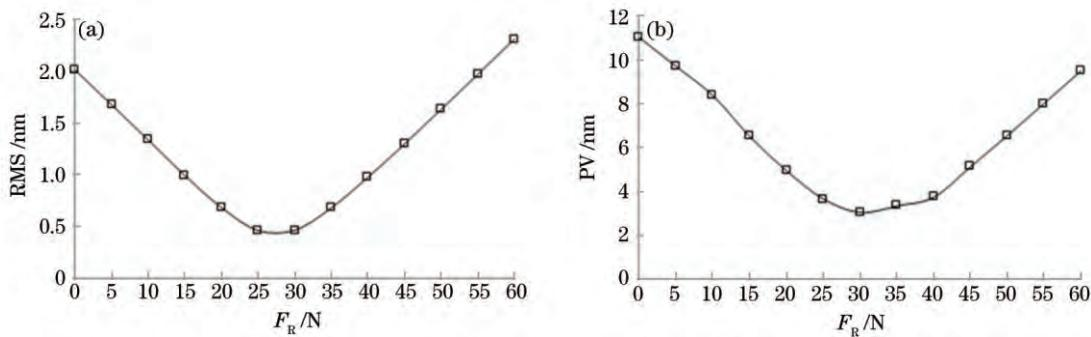
图 9 反射镜面形(a) RMS 值和(b) PV 值变化曲线
