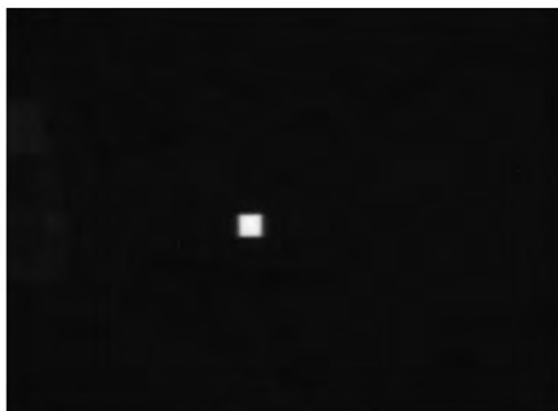
图 2 200 m 处中波红外摄像机得到的面源黑体图像
