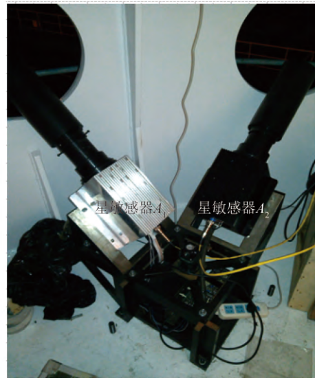
图 5 船载星敏器安装角标定试验
