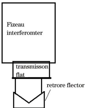
图2 平面干涉仪“猫眼”位置测量示意图
