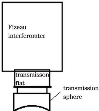
图 5 平面干涉仪“猫眼”位置测量示意图
