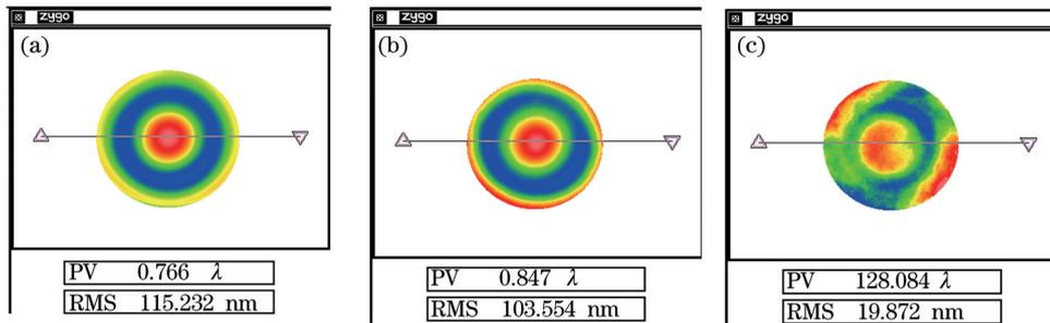
图 6 利用本文方法得到  $F=1.5$  标准具和干涉仪波前结果。(a) 标准具和干涉仪本身总体波前;(b) 单独检测的标准具波前;(c) 两者点对点相减结果
