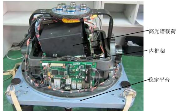
图 7 内框架装配在平台中的实物图
