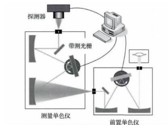
图1 光栅衍射效率测试原理图
