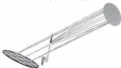
图9 测量单色仪中光学准直系统设计结果
