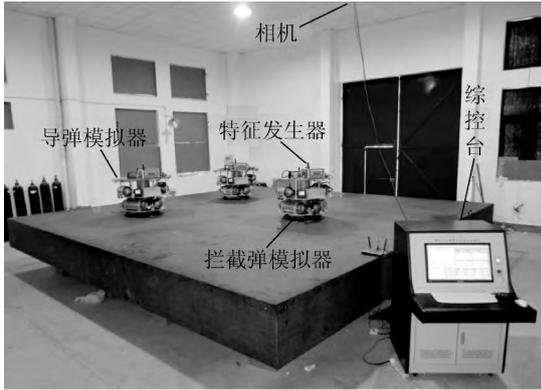
图 4 导弹突防效能模拟平台
