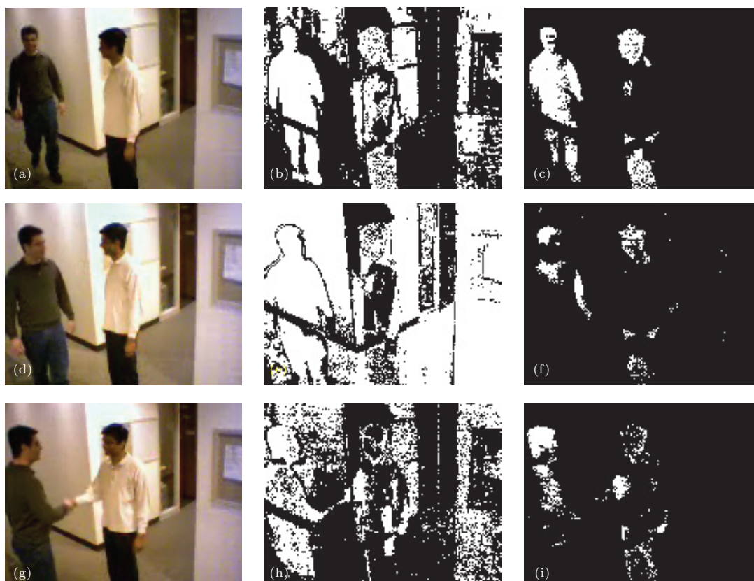
图7 (网刊彩色) 光照突变的前景检测结果 (a) 第110帧输入图像; (b) ViBe算法; (c) 本文算法; (d) 第125帧输入图像; (e) ViBe算法; (f) 本文算法; (g) 第170帧输入图像; (h) ViBe算法; (i) 本文算法
