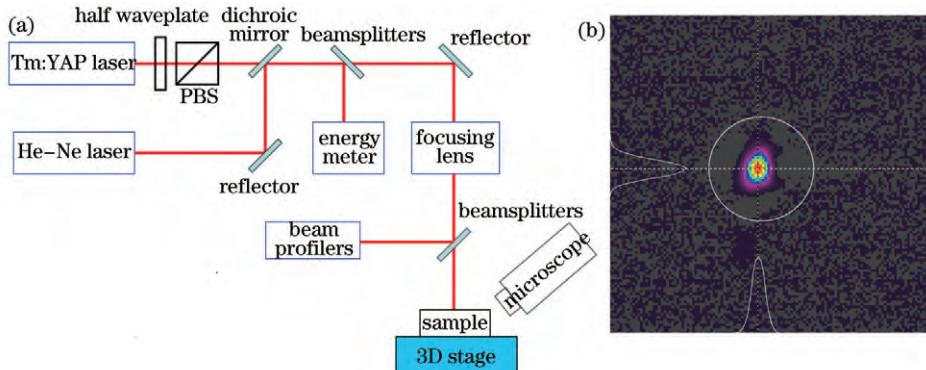
图4 激光损伤实验装置
