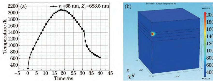
图9 杂质深度为 $683.5\text{ nm}$ 、半径为 $65\text{ nm}$ 、能量密度为 $3.2\text{ J/cm}^2$ 时杂质的温度计算。(a)杂质中心的温度变化曲线;(b)杂质在 $20\text{ ns}$ 时的温度分布云图
