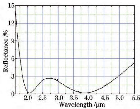
图 1 多层增透膜的剩余反射率测试曲线
