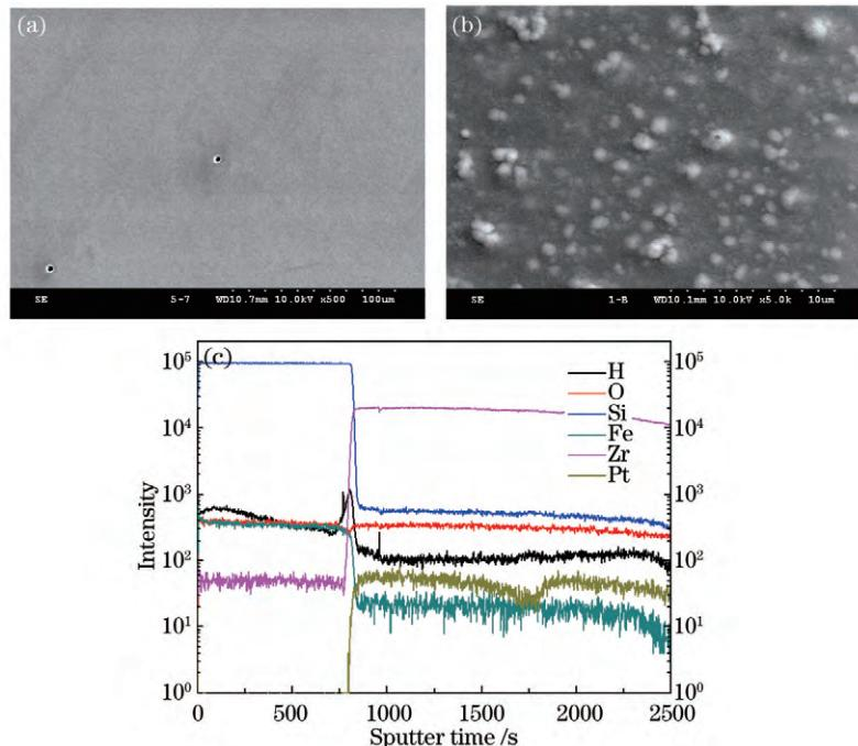
图3 ZGP增透膜的微观形貌及微量成分分析。(a) 500倍SEM下观察的ZGP晶体增透膜的表面形貌;
