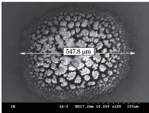
图 5 磷锗锌晶体薄膜激光损伤的 SEM 图
